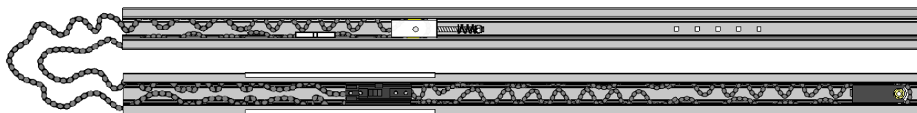
1 rail en 2 (ou 3) parties avec pignon / tendeur / chaîne / chariot (partie interne) montés
